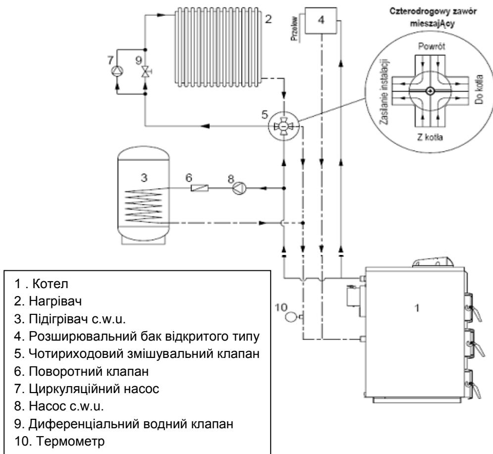
Рис. 7. Схема приєднання котла до опалювальної системи с.о. і с.в.у. з використанням чотириходового змішувального клапана
