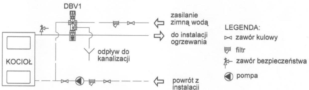
**Рис.6 Схема інсталяції з двоканальним запобіжним клапаном DBV1.**
